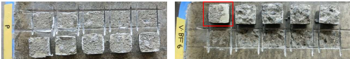
写真 3 接着試験後の試験体 左: 無処理 右: 真空脱水処理
